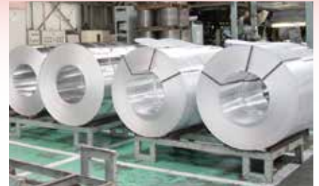
アルミを圧延した状態。用途に合わせて0.3mm～15mmの厚さに対応可能。
